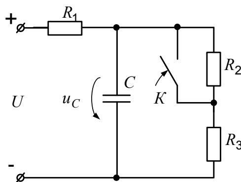
В цепи при замыкании ключа К происходит переходный процесс. Параметры цепи  $R_1 = 50 \Omega$ ,  $R_2 = 30 \Omega$ ,  $C = 81,25 \mu\text{F}$ ,  $R_3 = 80 \Omega$ ,  $U = 100 \text{ В}$ . Корень характеристического уравнения равен....
