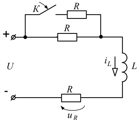
В цепи происходит коммутация. Напряжение источника  $U = 150$  В, активное сопротивление  $R = 50$  Ом. Тогда принужденная составляющая тока, протекающего через индуктивность равна ...
